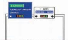
Figura II 232 Art. 127 SEGNALE DI DIREZIONE ALTO CON LANTERNE SEMAFORICHE INCORPORATE
